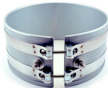
รูปที่ 5 แสดงการให้ความร้อนโดยฮีตเตอร์ไฟฟ้าในเครื่องฉีดพลาสติกในส่วนของ Barrel (ก่อนปรับปรุง)
