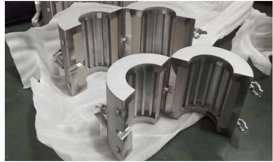
รูปที่ 6 แสดงการให้ความร้อนโดยหลอดอินฟราเรดในเครื่องฉีดพลาสติกในส่วนของ Barrel (หลังปรับปรุง)
