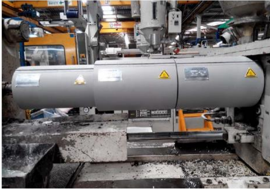
รูปที่ 6 แสดงการให้ความร้อนโดยหลอดอินฟราเรดในเครื่องฉีดพลาสติกในส่วนของ Barrel (หลังปรับปรุง)
