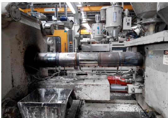
รูปที่ 5 แสดงการให้ความร้อนโดยฮีตเตอร์ไฟฟ้าในเครื่องฉีดพลาสติกในส่วนของ Barrel (ก่อนปรับปรุง)
